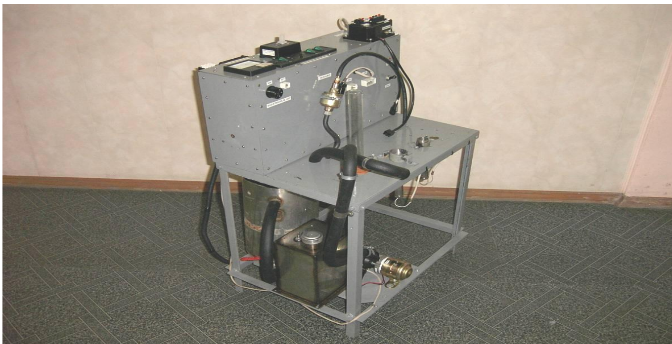
Рис. 13 – Стенд контроля подогревателя
