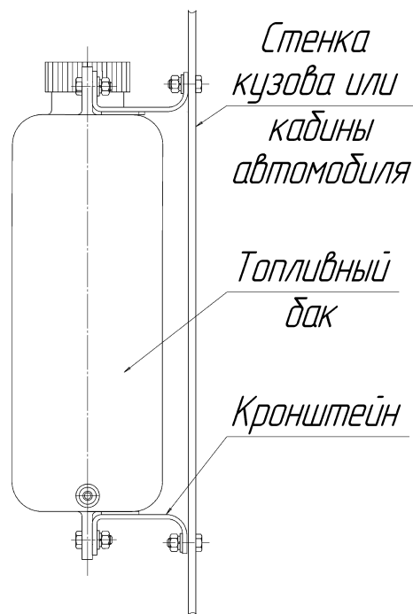
Рис. 6- Установка топливного бака на автомобиль.
